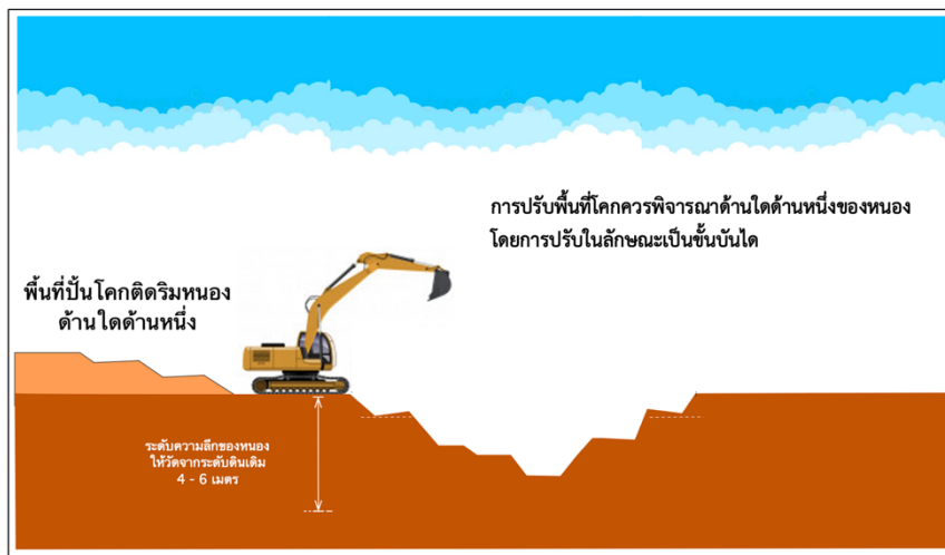
ภาพแสดงการปรับพื้นที่โคกด้วยดินจากการขุดหนอง
